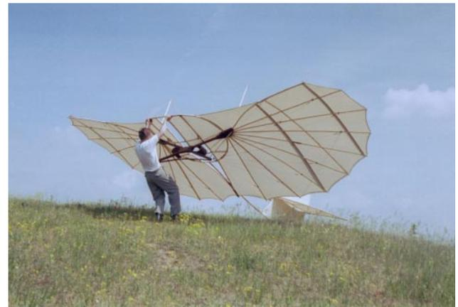
BILD 8: Nachbau 1994 - Normal Segelapparat
