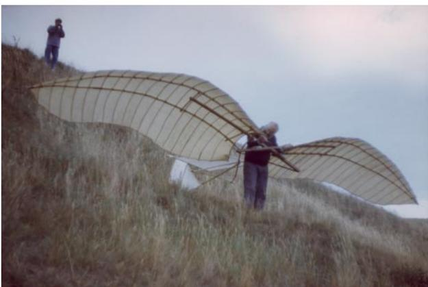
BILD 2: Nachbau 1987 - Derwitz-Apparat (ursprüngliche Form)
