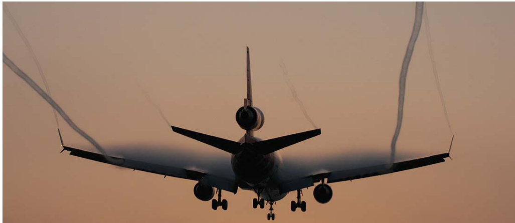
Bild 33: Vergleich einer Wirbelbildung an Winglets und unveränderter Randwirbel.
