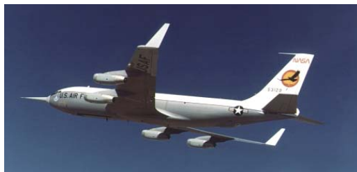
Bild 30: KC-135: Testflug mit Whitcomb-Winglets ohne untere Komponente.
