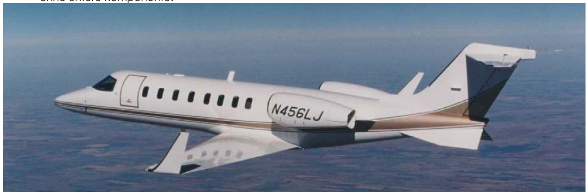
Bild 32: Learjet 28 während eines Testfluges. Erste Serienfertigung eines Flugzeuges mit Winglets.
