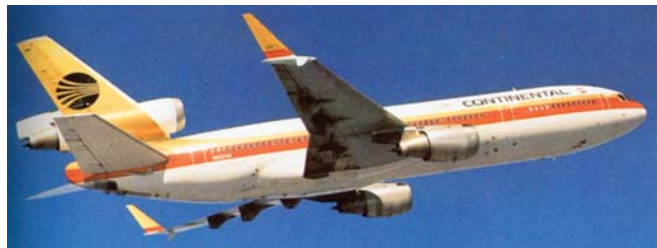
Bild 31: DC-10: Testflug mit ursprünglichen Whitcomb-Winglets.
