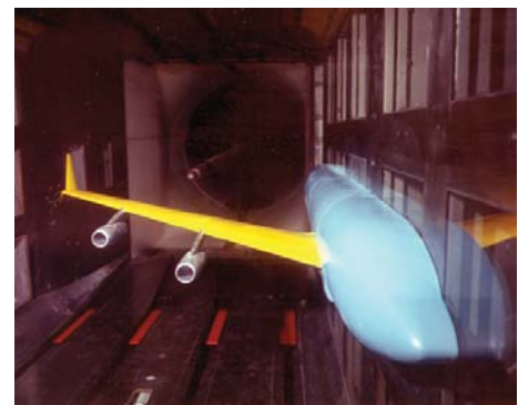
Bild 28: Windkanalmodell in Langley
